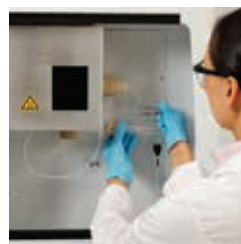
4) Abschließend wird das Probeneintragssystem mit der Plasmafackel verbunden
