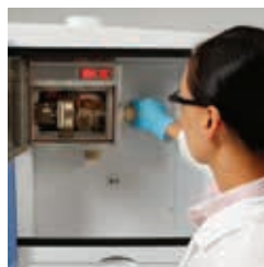
3) Plasmafackel- und axiales Interface werden installiert
