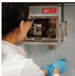
2) Die Induktionsspule wird in die gewünschte (horizontale) Richtung gedreht
