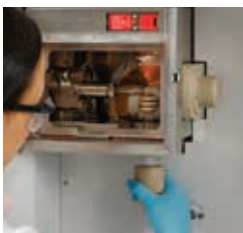
1) Plasmafackel und radiales Interface werden entfernt
