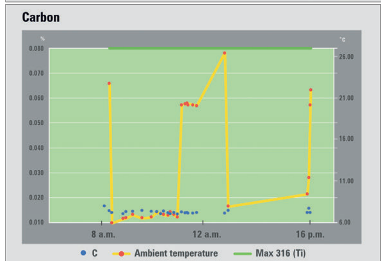
SPECTROTEST: Analytische Stabilität bei wechselnden Umgebungstemperaturen (Beispiel)
