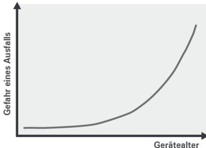
Die Erfahrung zeigt, dass ohne angemessene Wartung die Wahrscheinlichkeit einer Störung exponentiell mit dem Alter eines Gerätes steigt. Regelmäßige Wartung hingegen führt zu einer drastischen Verringerung des Ausfallrisikos und verlängert die Nutzungsdauer des Gerätes.
