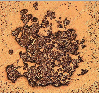
Abbildung 1: Nachgeschliffene Probe mit Vorfunkkrater
